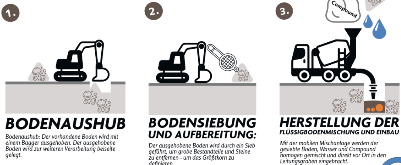
Abbildung 2: Schematische Darstellung zur Herstellung von LIQUID GROUND
